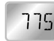
パスワード775点滅 (メーカーモード起動)
