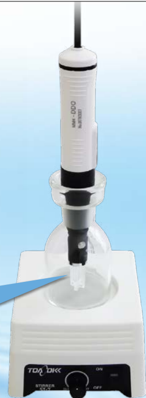
ふらん瓶はテーバ規格TS19/22 (容量100mL または 200mL) をご使用ください
